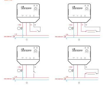
① 以上③④接线方式请确保设备 Lin 端供电输入正常, 否则会导致设备工作异常。
